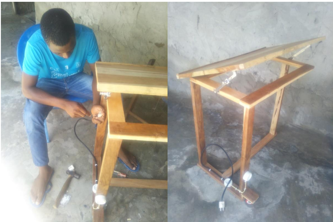
Apêndice 9: fixação das tomadas e a devida instalação de condutores. Fonte: Autor, 2020
