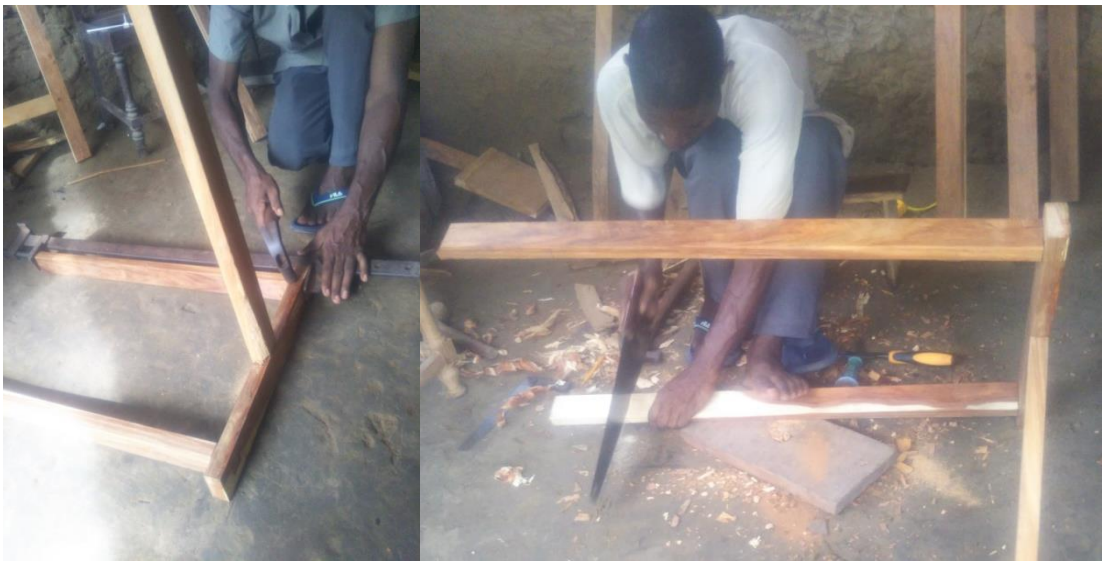
Apêndice 7: Trabalho conjunto com carpinteiro para a concretização da mesa. Fonte: Autor, 2020
