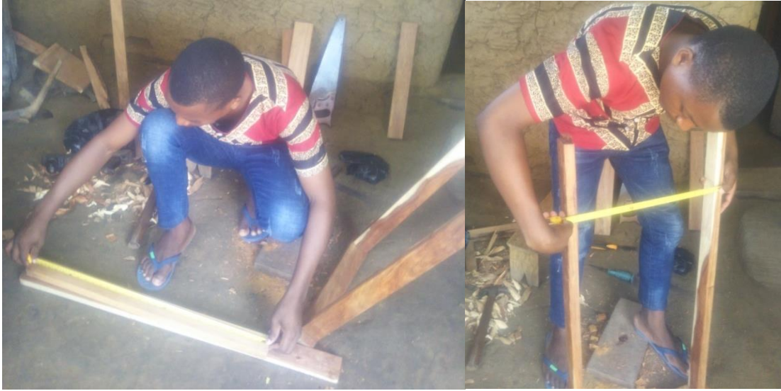
Apêndice 6: Momento de organização e dimensionamento das peças do material para produção da mesa. Fonte: Autor, 2020
