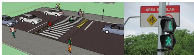
Figura 9: Proposta de projeto para pedestre: faixa elevada e semáforo temporizador
