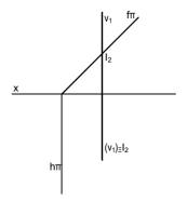
Intersecção da recta de nível com plano o plano vertical (projectante horizontal), primeiro acha-se o ponto na projecção horizontal.
