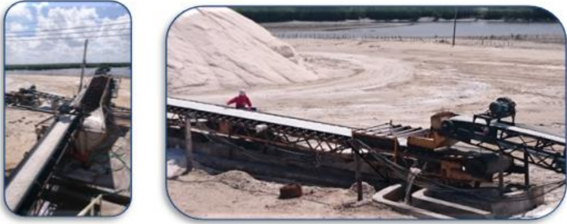
Figura 6 – Processo de lavagem por meio de lavador e por spray.
