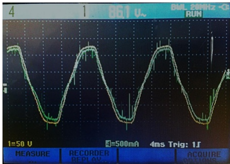
Figura 19. Tensão de Entrada e Corrente de entrada à 86,1Vrms.
