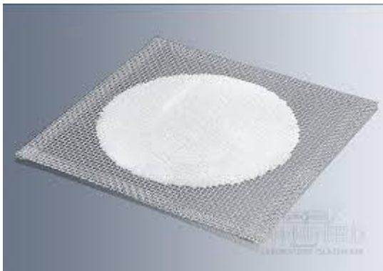
Figura 14 - Tela de amianto.
