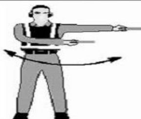
Figura 1-29/B DESLOCAMENTO HORIZONTAL PARA A DIREITA (DO PONTO DE VISÃO DO PILOTO) (helicóptero em voo)
