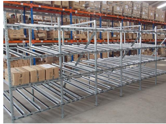
Figura 7 Estrutura Flow Rack construída
