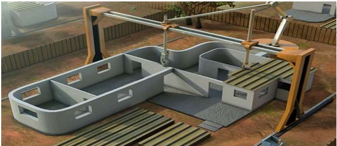
Figura 17: protótipo de impressora 3D que constrói casas inteiras.
