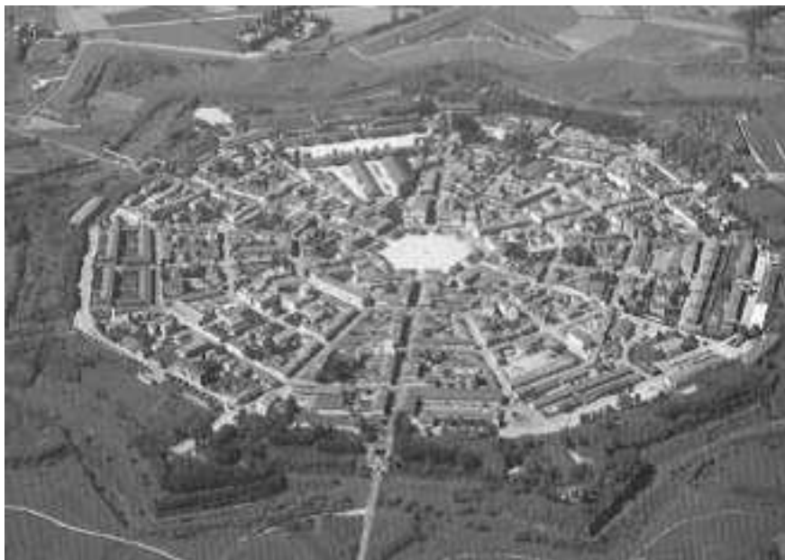
FIGURA 04 - Palmanova, Itália. A forma da cidade, de traçado regular e concêntrico, está inserida em um polígono regular de oito lados, em cujos vértices são construídos contrafortes para facilitar a defesa da cidade. A forma das muralhas também é modificada em função da introdução de novos armamentos — principalmente o canhão — e de novas táticas de guerra. Esta forma de cidade será conhecida como “planta em estrela”.
