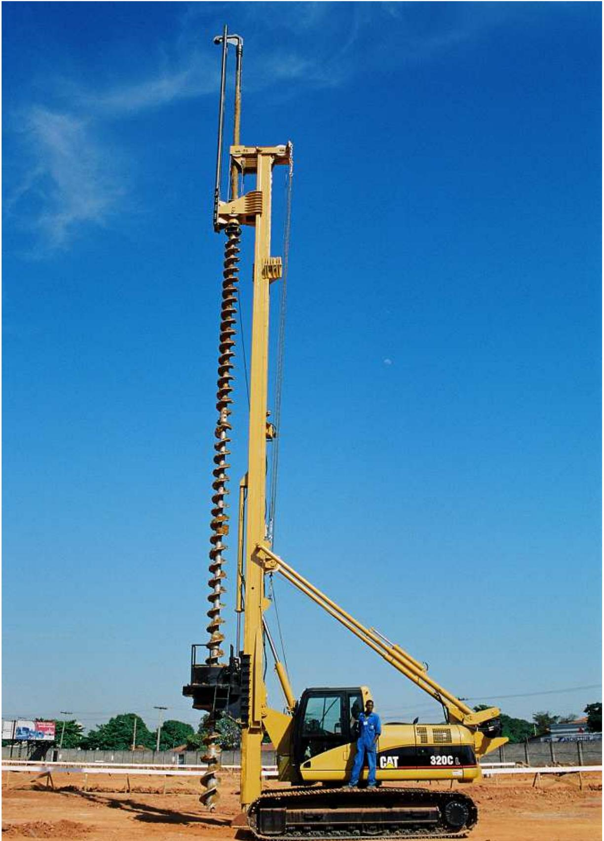
**Figura 3.3: Equipamento para perfuração de estaca hélice-contínua.**
