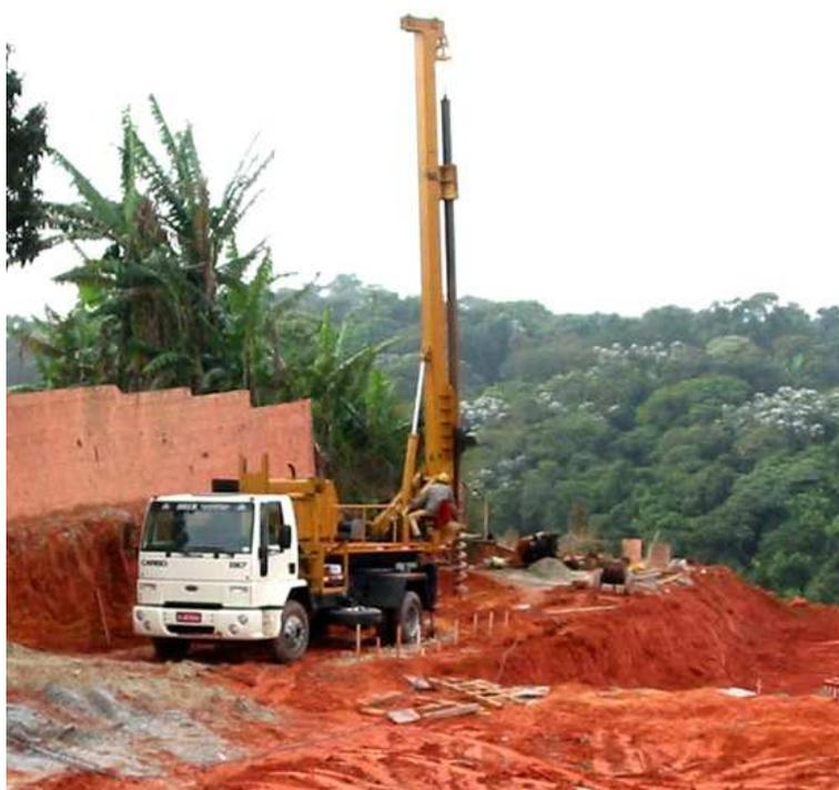
**Figura 2.2: Caminhão equipado com sistema de perfuratriz através do trado-helicoidal.**
