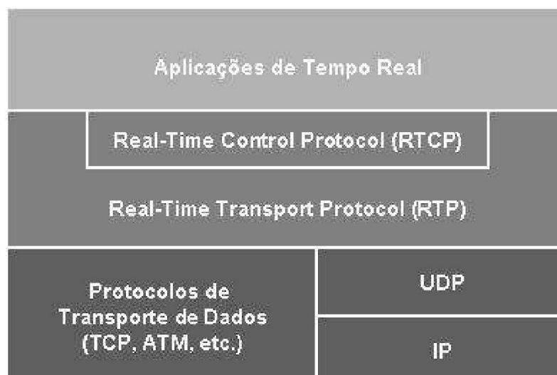
Figura 8: Relação do protocolo RTP com outros protocolos e aplicações (LIMA, 2003)
