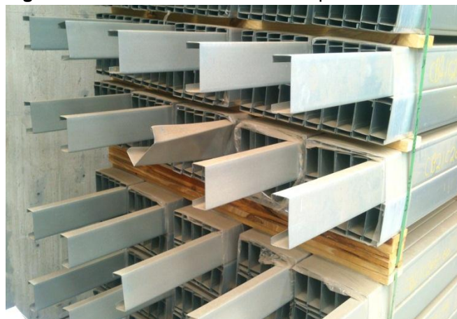
Figura 1 – Perfis danificados no transporte.
