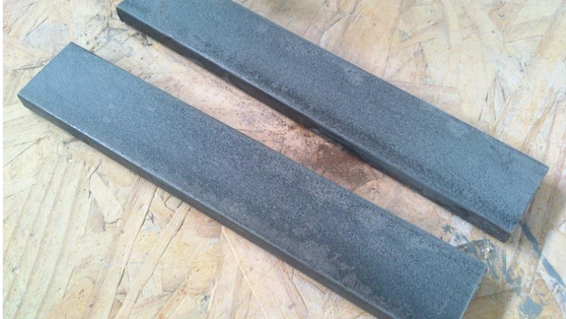
Figura 10 – Aço após aplicação do spray.
