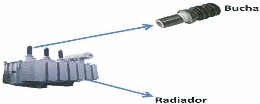
**Figura 3 – Itens de UAR dos transformadores**
