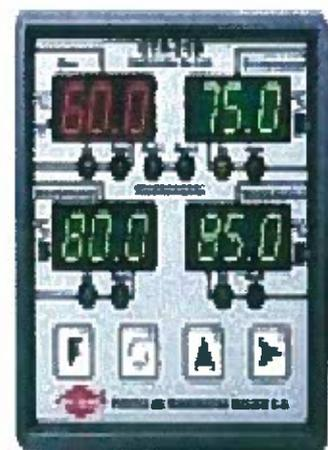
**Figura 4 – COM dos transformadores**
